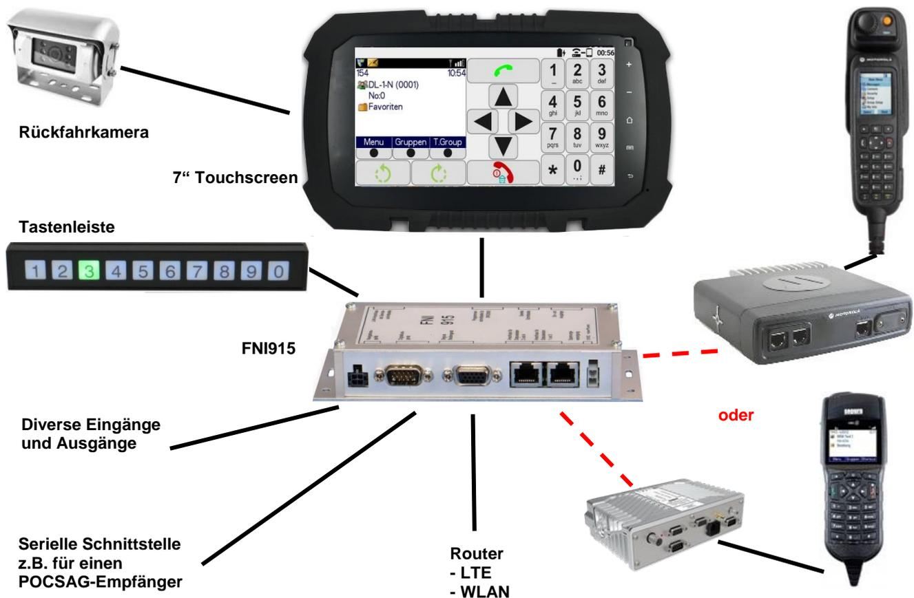
Das Funk-Navigations-Interface **FNI915 plus** verbindet die Funktionen des FNI915 *Basic* mit den Bedienoberflächen des CARINA *Basic* System. Die Programmierung des Systems erfolgt mit dem erweiterten FNI-Konfigurator.
