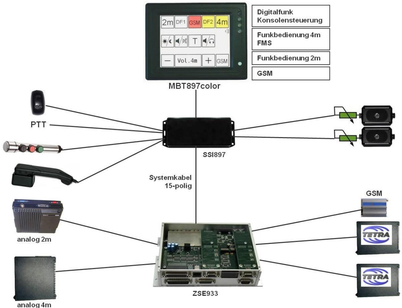
Mit dem Bedienteil **MBT897color** steht eine Lösung zur Verfügung, welche optimal auf die Anforderungen des verdeckten Einbaus in Einsatzfahrzeugen abgestimmt ist. Die kompakte und leichte Bauweise ermöglicht den Einbau auch in kleinsten Nischen im Fahrzeug.
